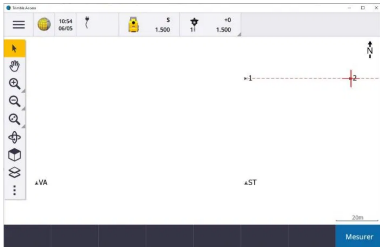
Installé sur la première station intermédiaire (1), visée arrière sur ST puis mesurer la seconde station intermédiaire (2)
